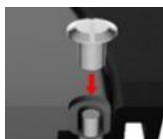
Abdeckungen mit Stehbolzen und Hohlmutter verschraubt
