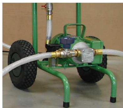
Čerpadlo a multifunkční kohout
